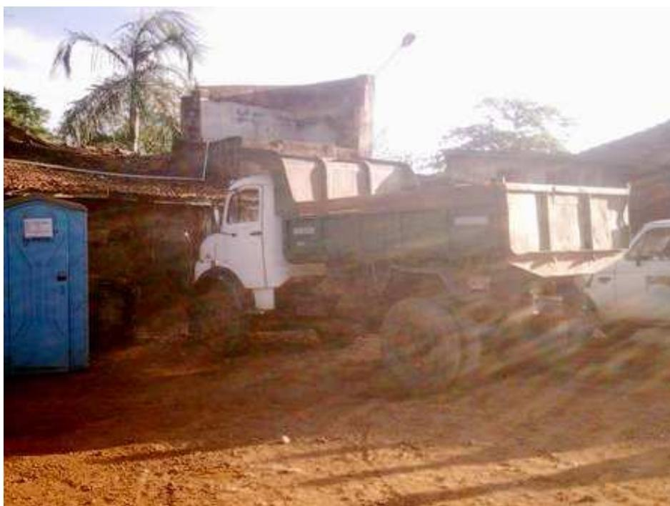
Foto 06 – Caminhão MB 1113 utilizado na coleta dos RSU – jul/08
